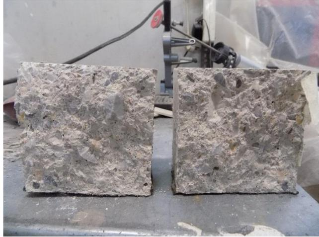
Рис.4 Разделенный образец с нулевым проникновением воды
