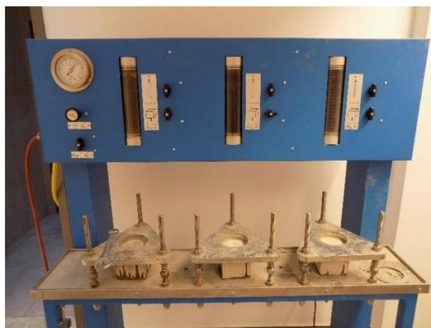
Рис.2 Установка для испытания на проникновение воды
